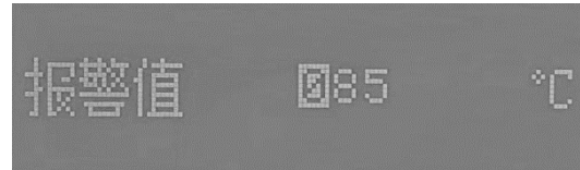
图 4.4.3-4 温度报警值设置界面
