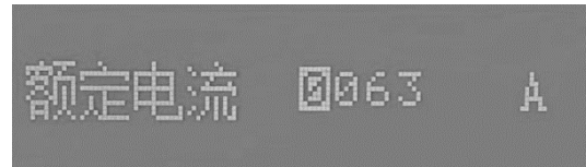
图 4.4.4-6 额定电流设置界面
