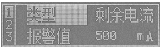
图 4.4.3-1 剩余电流和温度类型设置菜单
