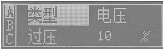
图 4.4.6-1 电压通道模式选择界面
