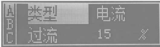
图 4.4.4-1 电流通道模式选择界面
